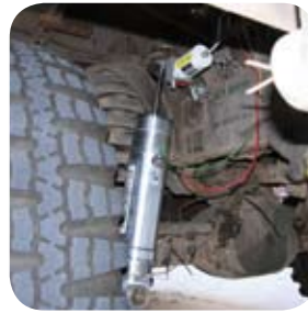
Dämpfungsregelung an einem LKW © TU Wien
