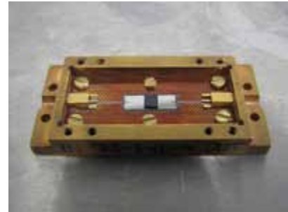
Im Zentrum: Der Quantenchip, der Diamanten mit einem Mikrowellenresonator koppelt
