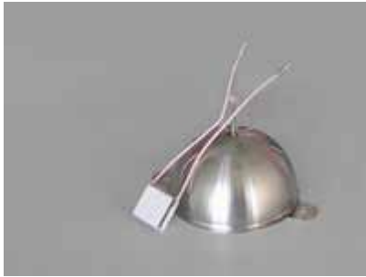
Kleine Sensoren für die Flugzeughülle, die sich selbst mit Energie versorgen
