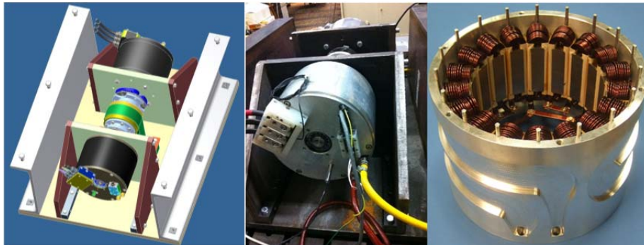
Abb.2: Entwurf und Aufbau eines 90 kW-PM-Synchronmotors (ESEA, TU Wien)
