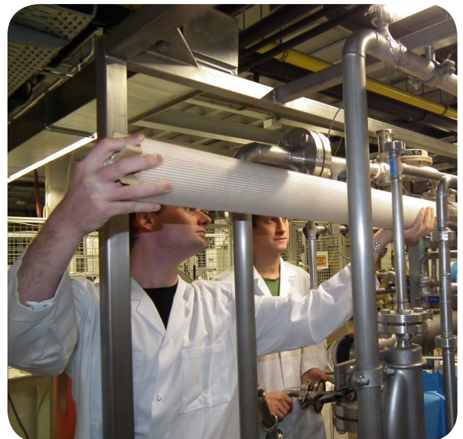
Bestückung der Pilotanlage mit Nanofiltrations Membran
