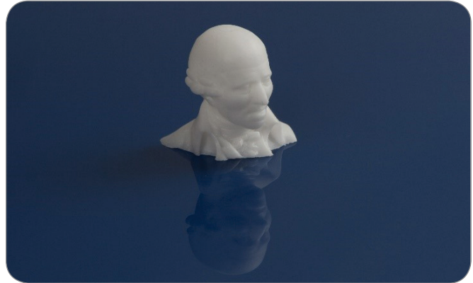
Joseph Haydn - mit 3D Druck - aus Al 2 O 3
