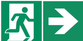
Abbildung 2: E002 Notausgang (rechts) gem. ISO 7010:2012 und Pfeil Typ D nach ISO 3864-3:2012
